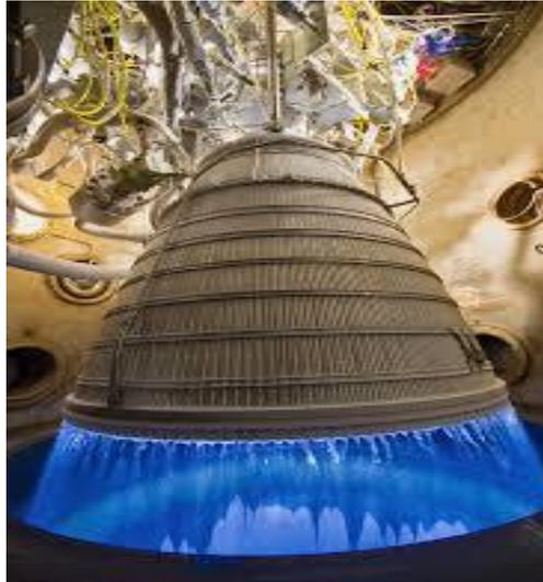
**Figure I.3** : Tuyère propulsive d'un moteur fusée.
