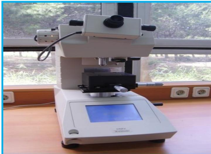
Figure 4-12: Microduromètre digital Shimadzu HMV-2.
