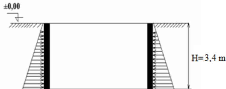
Figure VII.9 : Poussées des terres.
