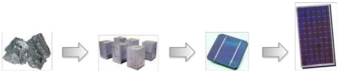
Figure 1.3 : La fabrication des plaques, cellules et modules photovoltaïques [6]
