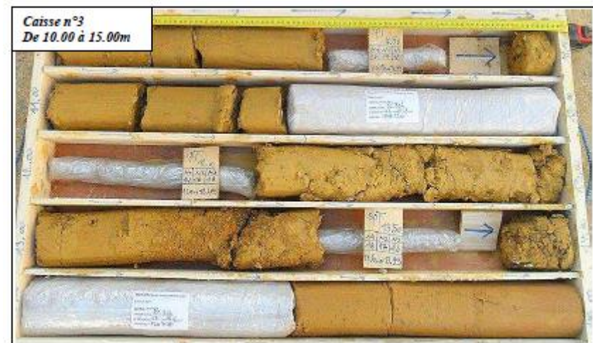
Figure A. 11 : Caisse de carotte n°=3 (SC 306) profondeur (10 à 15m).
