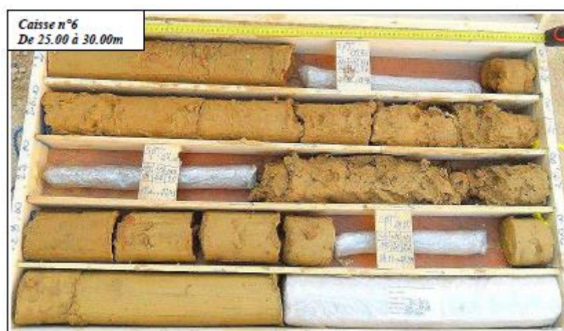
Figure A. 14 : Caisse de carotte n°=6 (SC 306) profondeur (25 à 30m).
