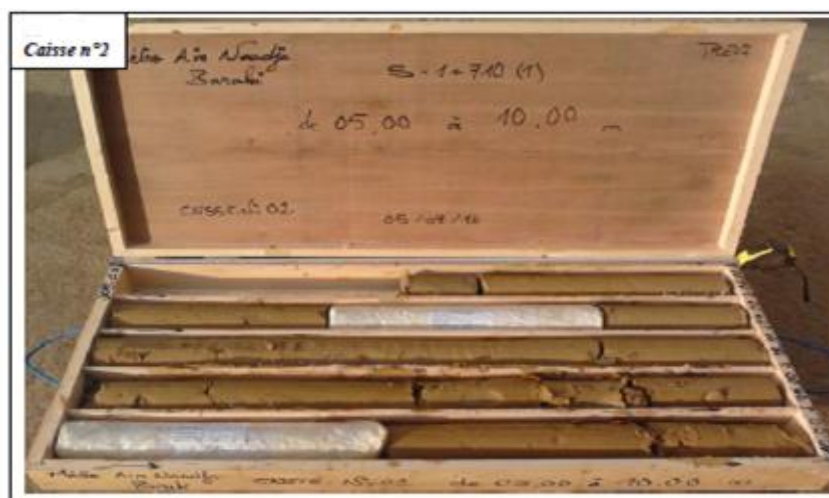
Figure A. 17 : Caisse de carotte n°=2 (SC 750) profondeur (5.00 à 10m).
