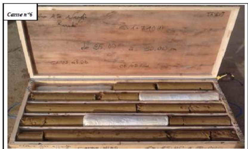
Figure A. 21 : Caisse de carotte n°=6 (SC 750) profondeur (25 à 30m).
