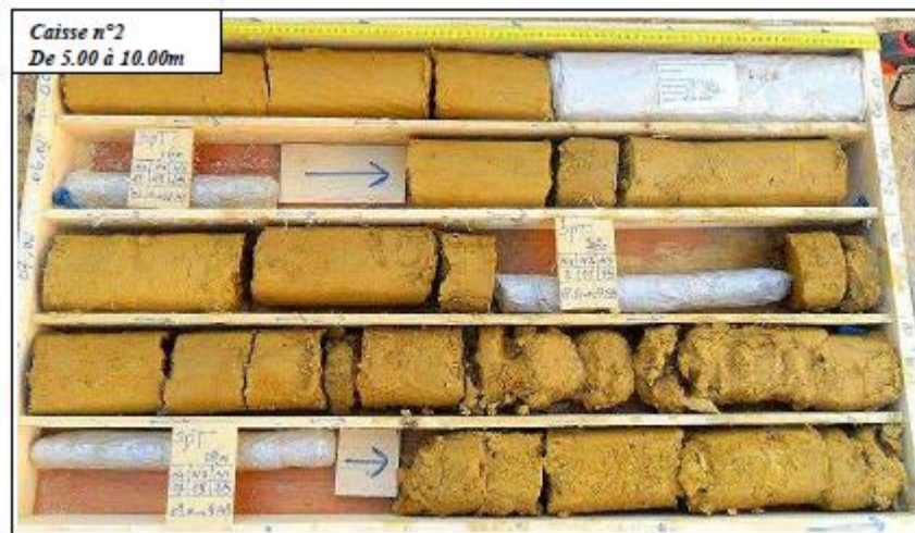
Figure A. 10 : Caisse de carotte n°=2 (SC 306) profondeur (5.00 à 10m).
