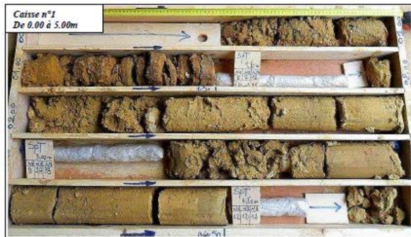
Figure A. 2 : Caisse de carotte n°=1 (SC 305) profondeur (0.00 à 5m).
