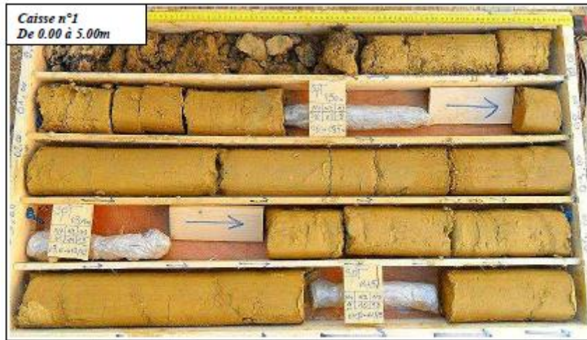
Figure A. 9 : Caisse de carotte n°=1 (SC 306) profondeur (0.00 à 5m).
