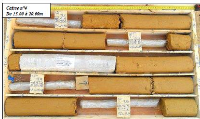
Figure A. 12 : Caisse de carotte n°=4 (SC 306) profondeur (15 à 20m).
