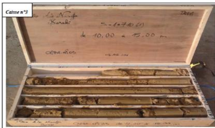
Figure A. 18 : Caisse de carotte n°=3 (SC 750) profondeur (10 à 15m).
