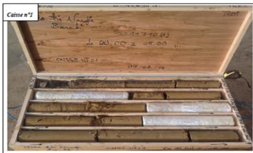
Figure A. 16 : Caisse de carotte n°=1 (SC 750) profondeur (0.00 à 5m).
