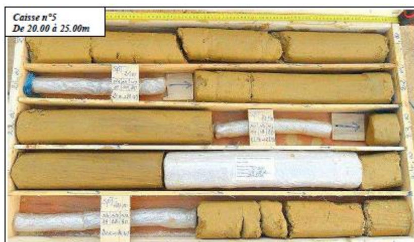
Figure A. 13 : Caisse de carotte n°=5 (SC 306) profondeur (20 à 25m).
