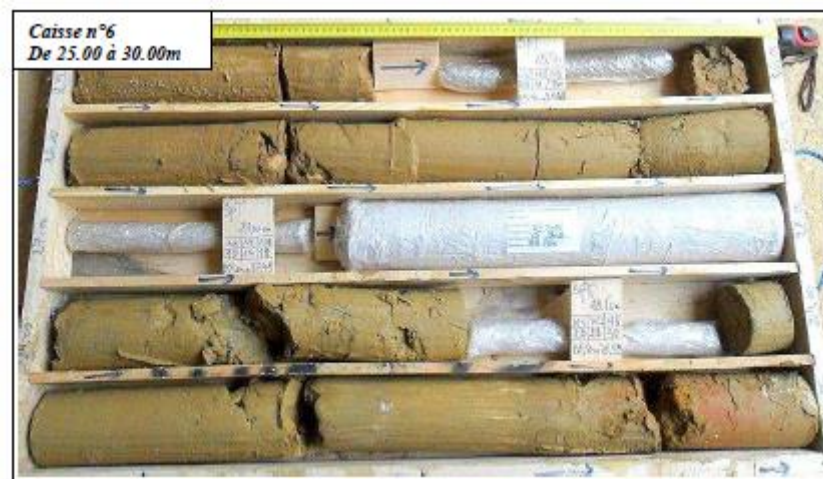
Figure A. 7 : Caisse de carotte n°=6 (SC 305) profondeur (25 à 30m).
