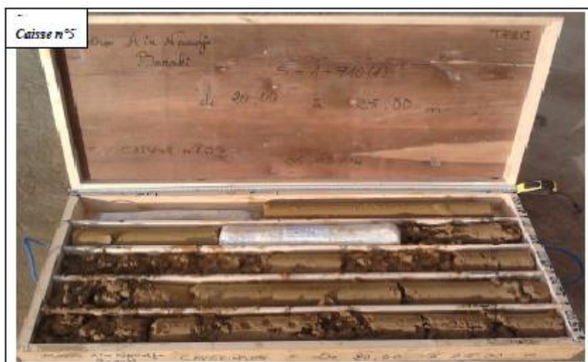
Figure A. 20 : Caisse de carotte n°=5 (SC 750) profondeur (20 à 25m).
