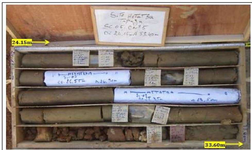
**Figure V.2:** Echantillons du sol extrait par sondage carotté au site étudié.
