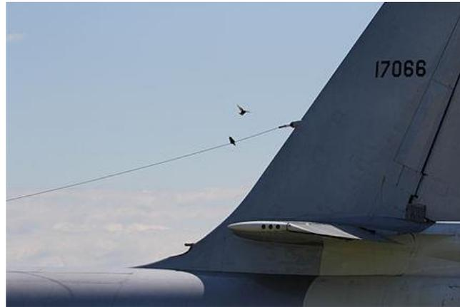
**Figure I.16 : L'antenne long-fil**
