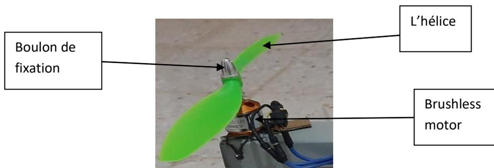
Figure 6.2.b : placement l'hélice avec le moteur
