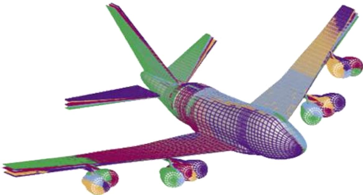
**Figure (I.4) :** Modèle montrant les déformations dues à l'aéroélasticité que peut subir un avion.
