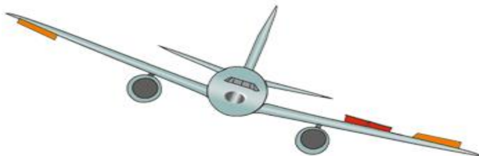
Figure II.3. Moment de roulis créé par les ailerons et les spoilers [4]
