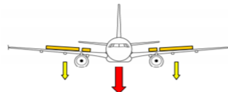
Figure II.4. Braquage des spoilers lors de la descente d'urgence. [4]
