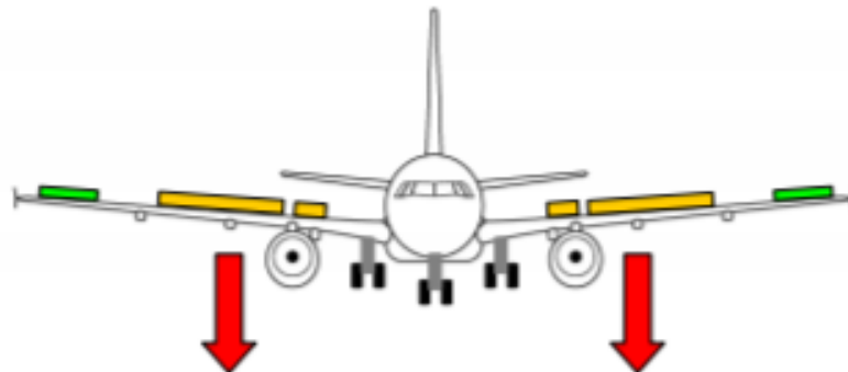
Figure II.5. Braquage des spoilers pour créer de la déportance lors de l'atterrissage. [4]
