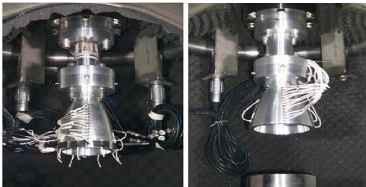
Fig. 1.23- Tuyères TIC et TOC du DLR [18].
