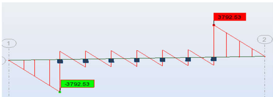
Figure V-2 : Diagramme des efforts tranchants à l'ELU (1,35G + 1,6A (I)).
