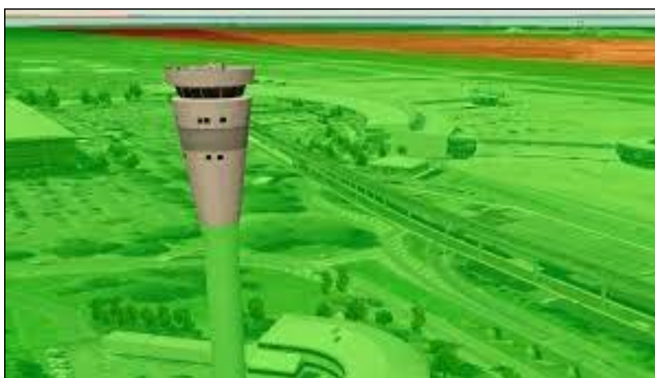
Figure 2-12 : Tour de contrôle et surface de dégagement. [15]
