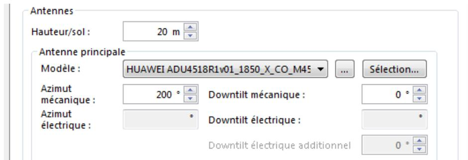
Figure 38 : L'onglet permettant de modifier le tilt mécanique, le tilt électrique et l'azimut
