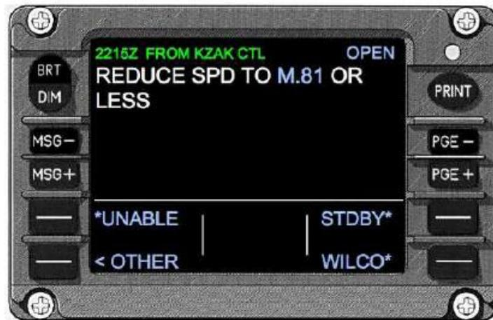
**Figure (I.1) :** Interface du pilote pour les messages CPDLC [8].
