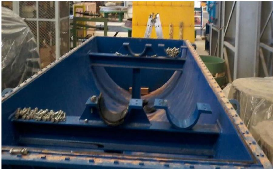
Figure 08 : Enceinte pour Rotor (partie basse). [03]
