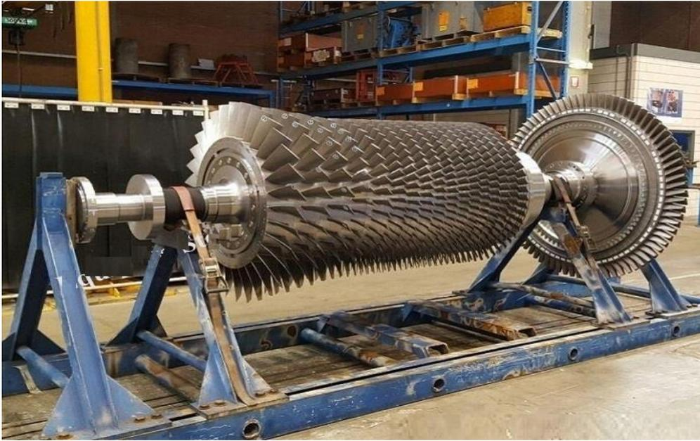
*Figure 06 : Rotor de la turbine à gaz MS5002C. [03]*
