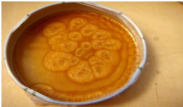
Figure 1.16 - Image réelle d'apparition des cellules Rayleigh-Bénard après l'expérience physique.
