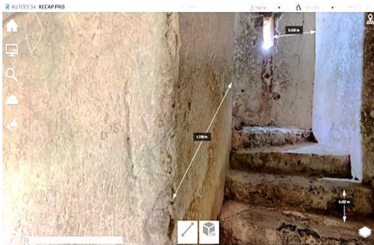
Figure 2.37 Acquisition du levé géométrique à l'intérieur du minaret à l'aide de RecapPro.
