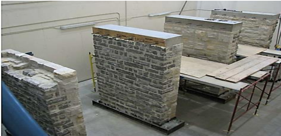
Figure 1.10 Essai de la compression axiale sur les murs en maçonnerie de pierre et du mortier à chaux hydraulique.
