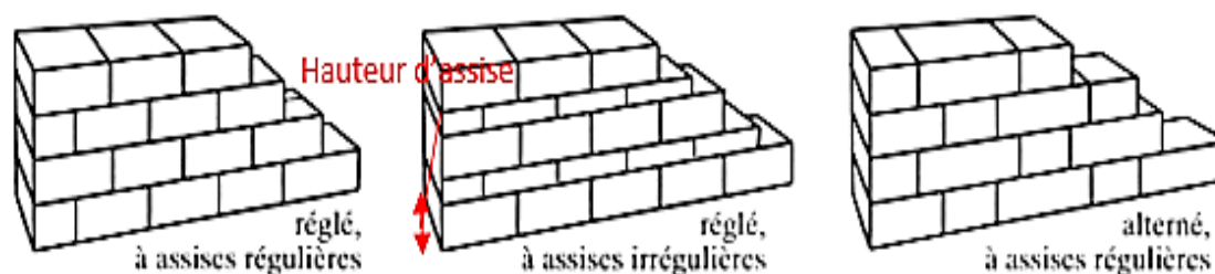
Figure 1.2 Exemple d'appareil à épaisseur simple. [3]
