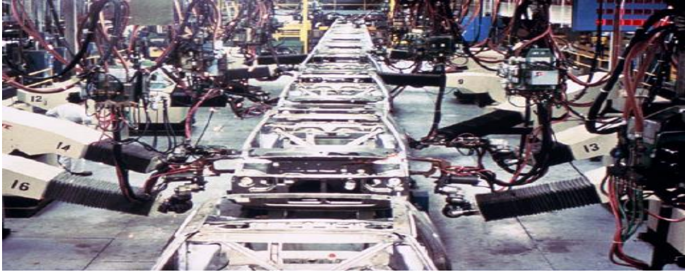
Fig. (1.5) la première ligne robotisée contenant 26 robots soudeurs Unimate.
