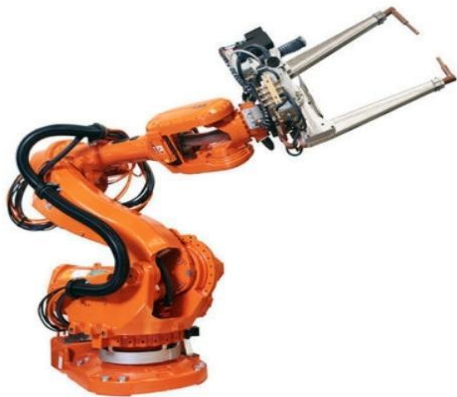
Fig. (1.18) Robot manipulateur dédié au soudage par point
