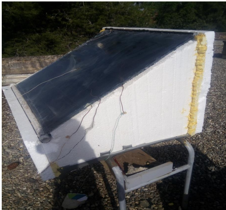
Figure IV.2 : Montage final du distillateur à cascade.
