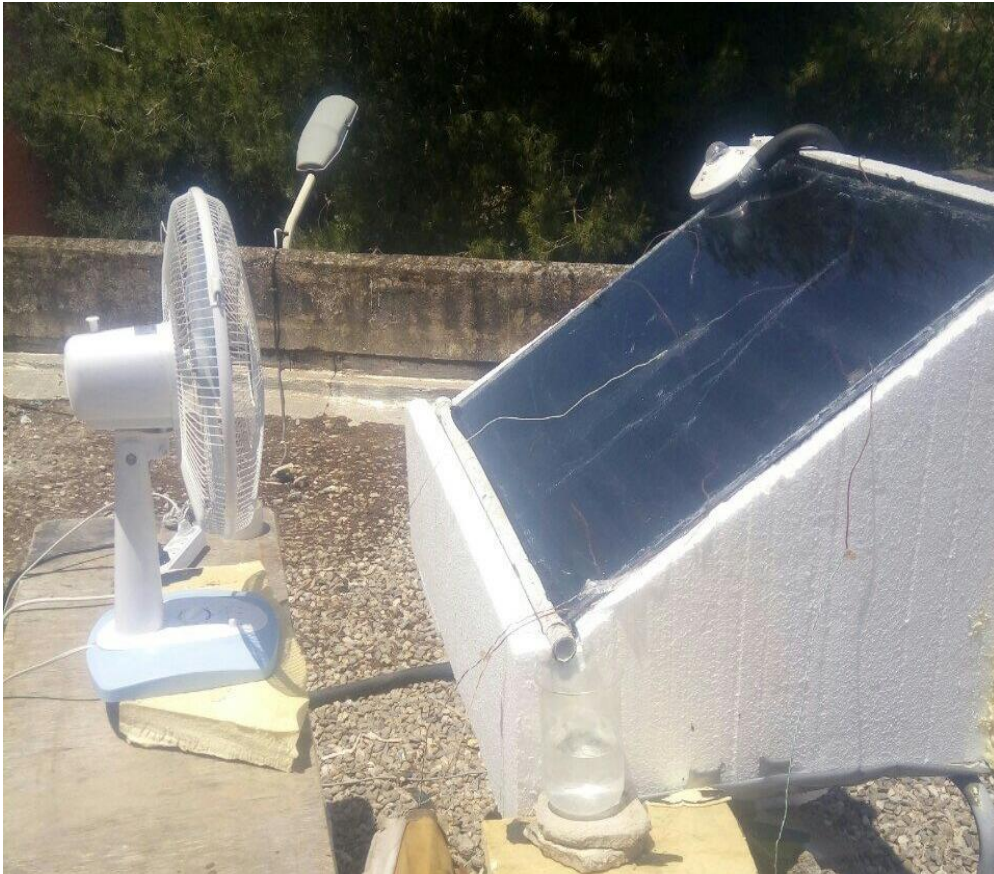
Figure IV.45 : Refroidissement de la face extérieure de la couverture par un ventilateur.
