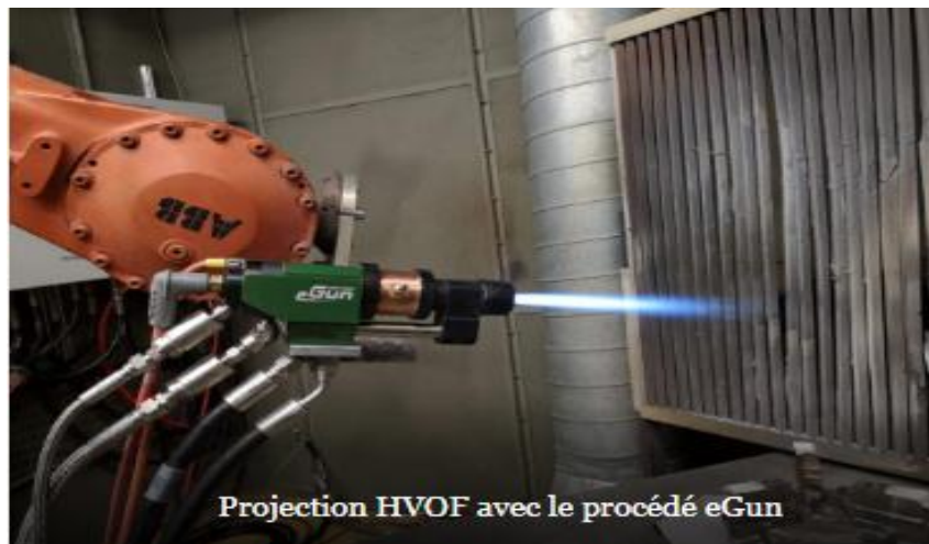
Figure 1.11 : type d'opération projection HVOF [12]
