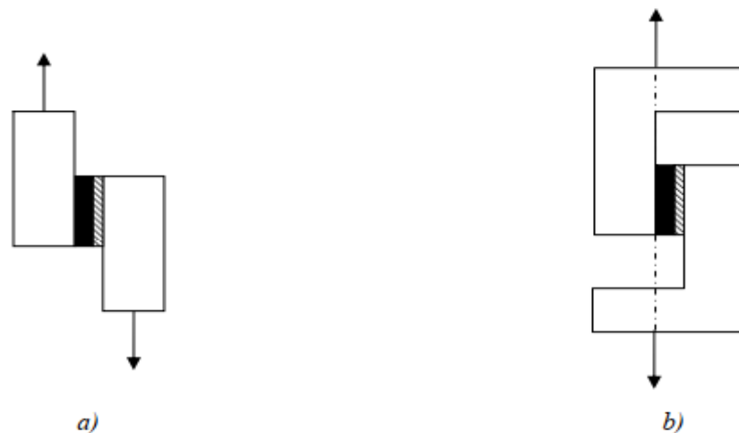
Figure 4.4 : Schémas de deux essais de cisaillement. a) standard. b) corrigé [84]
