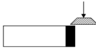
Figure 4.5 : Schéma de l'essai de cisaillement sans colle [85]
