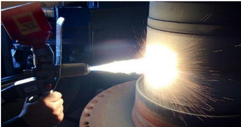
Figure 1.8: Opération d'un pistolet flamme poudre [12]
