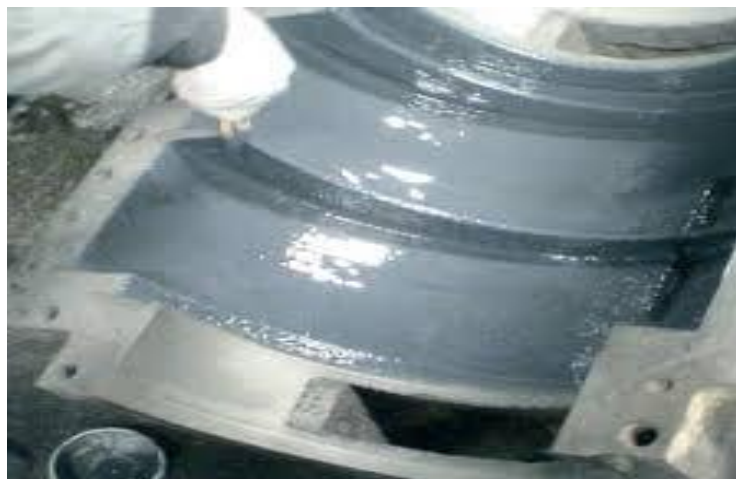
Figure 3.16 : solution de préparation des surfaces [75]
