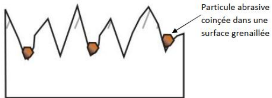
Figure 3.11: Présence de particules abrasives après grenailage [75]
