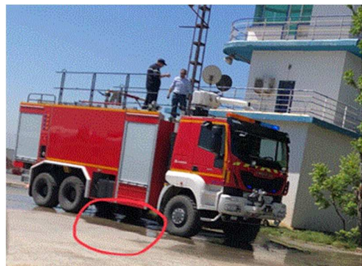
Figure 2.3 : Camion du SSLI près de la DOS en fuite d'eau.
