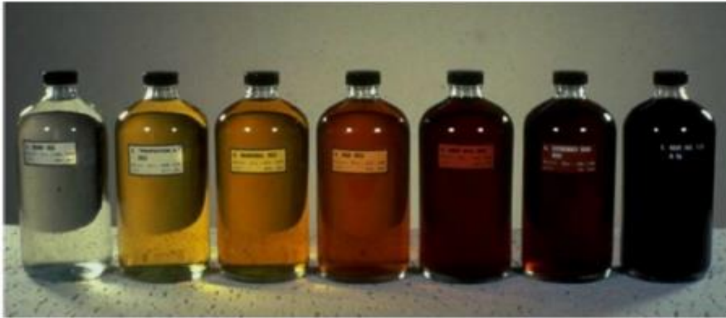
Figure I.3: Echantillons d'huiles présentant l'oxydation de l'huile [22].
