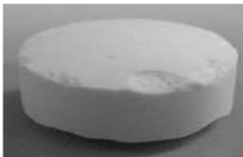
Figure II.4 : Ebrèchement d'un comprimé [18]
