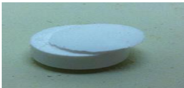
Figure II.9 : Phénomène de décalottage d'un comprimé [22]
