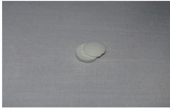
Figure III.3 : Comprimé de Rapidus ® décalotté.
