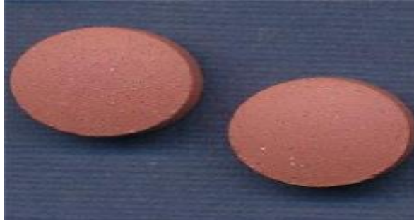
Figure II.7 : aspect d'une peau d'orange observé sur des comprimés
