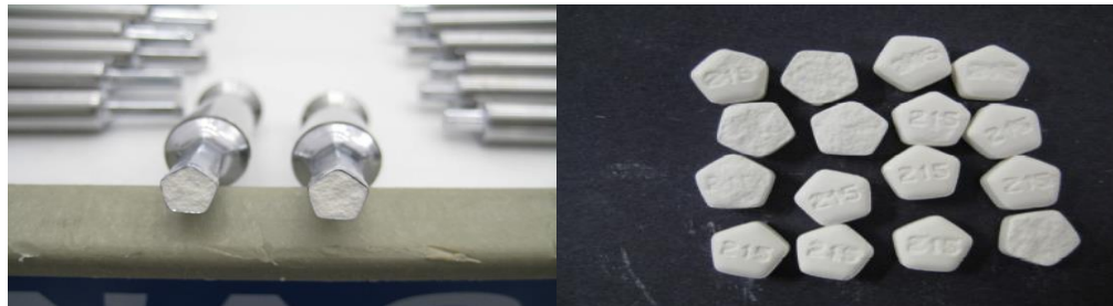
Figure II.2 : Les effets du collage des comprimés observés lors de la fabrication
