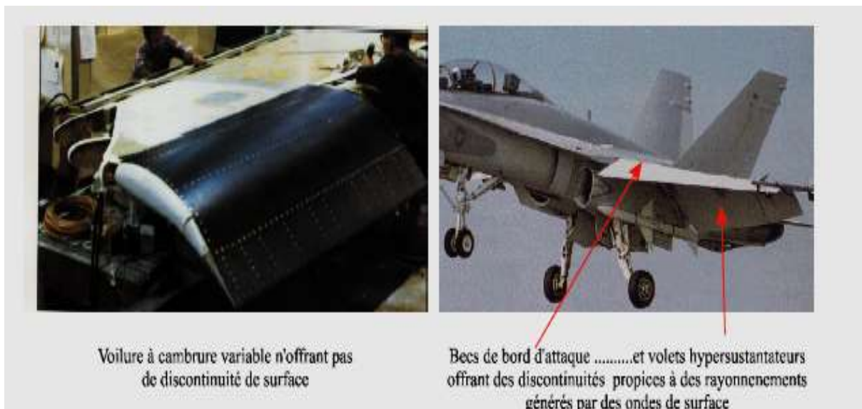
Fig III.19 : Traitement des discontinuités des volets et bords d'attaques [33]
