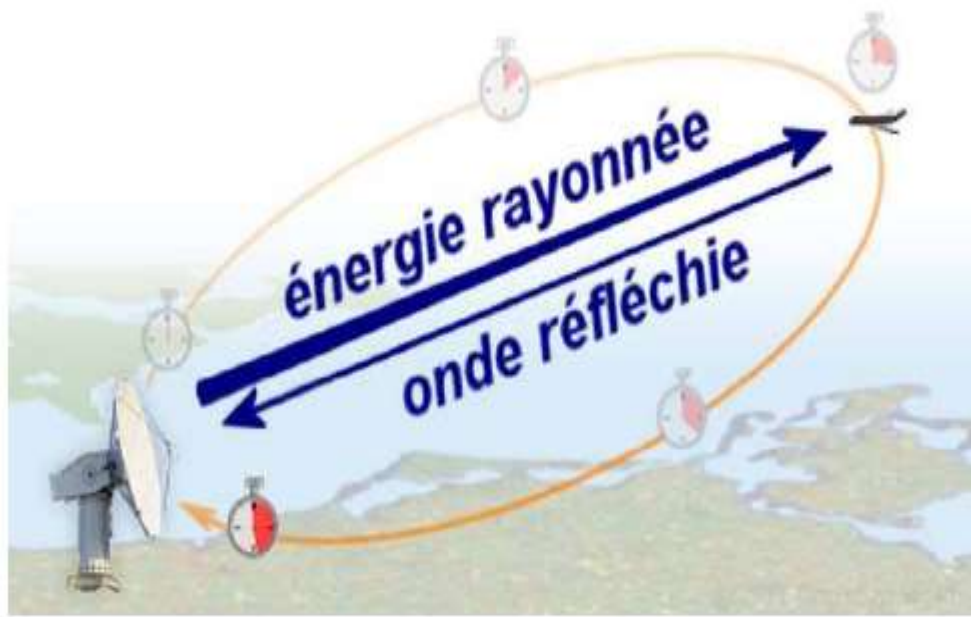
Fig I.4: Principe de l'émission du radar [5]
