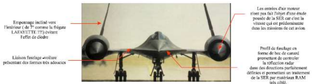
Fig III.15 : Éléments contributeurs à la réduction de la SER du SR 71 [32]
