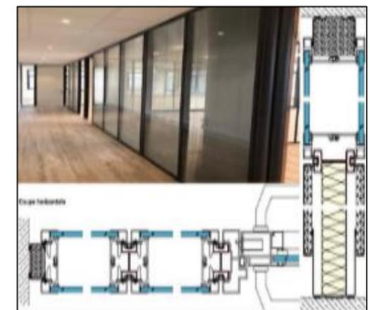
Figure 5.29 : coupes d'une cloison vitrée
