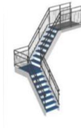
Figure 6 : escalier en charpente métallique.
