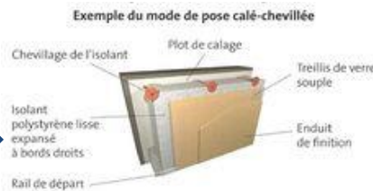
Figure104 : l'isolation calé-chevillé La source : https://www.ffbatiment.fr/federation-francaise-du-batiment/laffb/mediatheque/batimetiers.html?ID_ARTICLE=2
