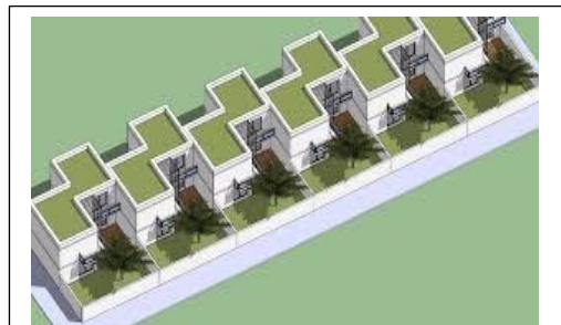
Figure 7 : Maisons en bande et maisons jumelée
