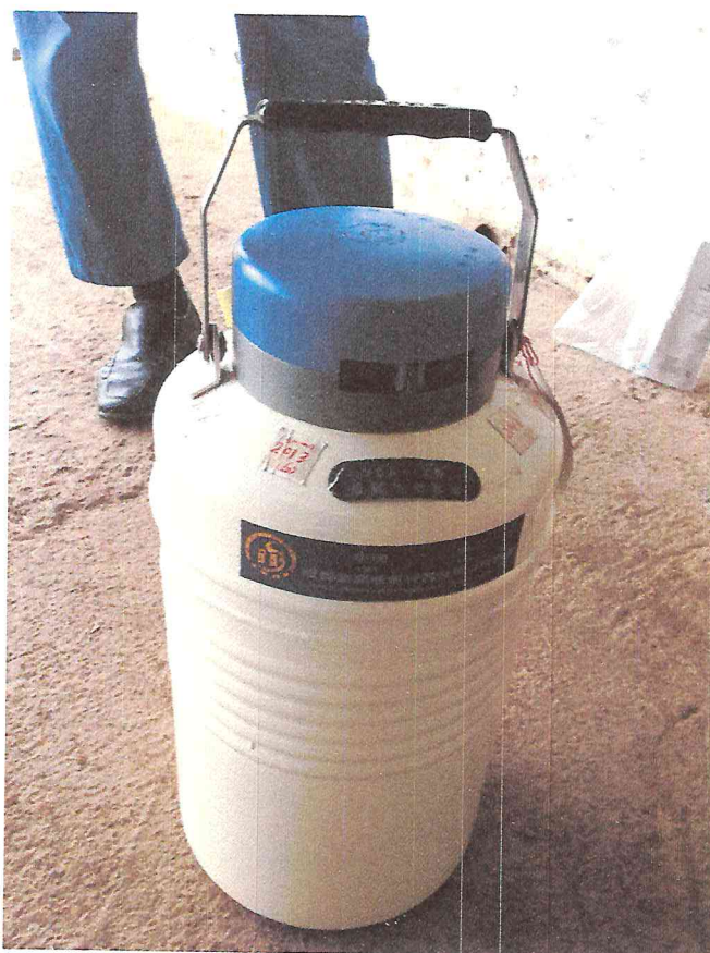
Photo B: Cuve d'azote
