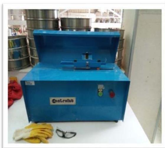
Figure IV.8 : Diviseur échantillonneur du sable et une Machine d'agitation.
