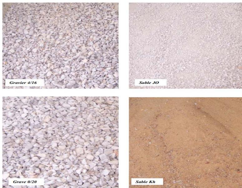
Figure I.3 : Matériaux granulaires composants les mélanges de BCR (Sables, Graviers, Graves).
