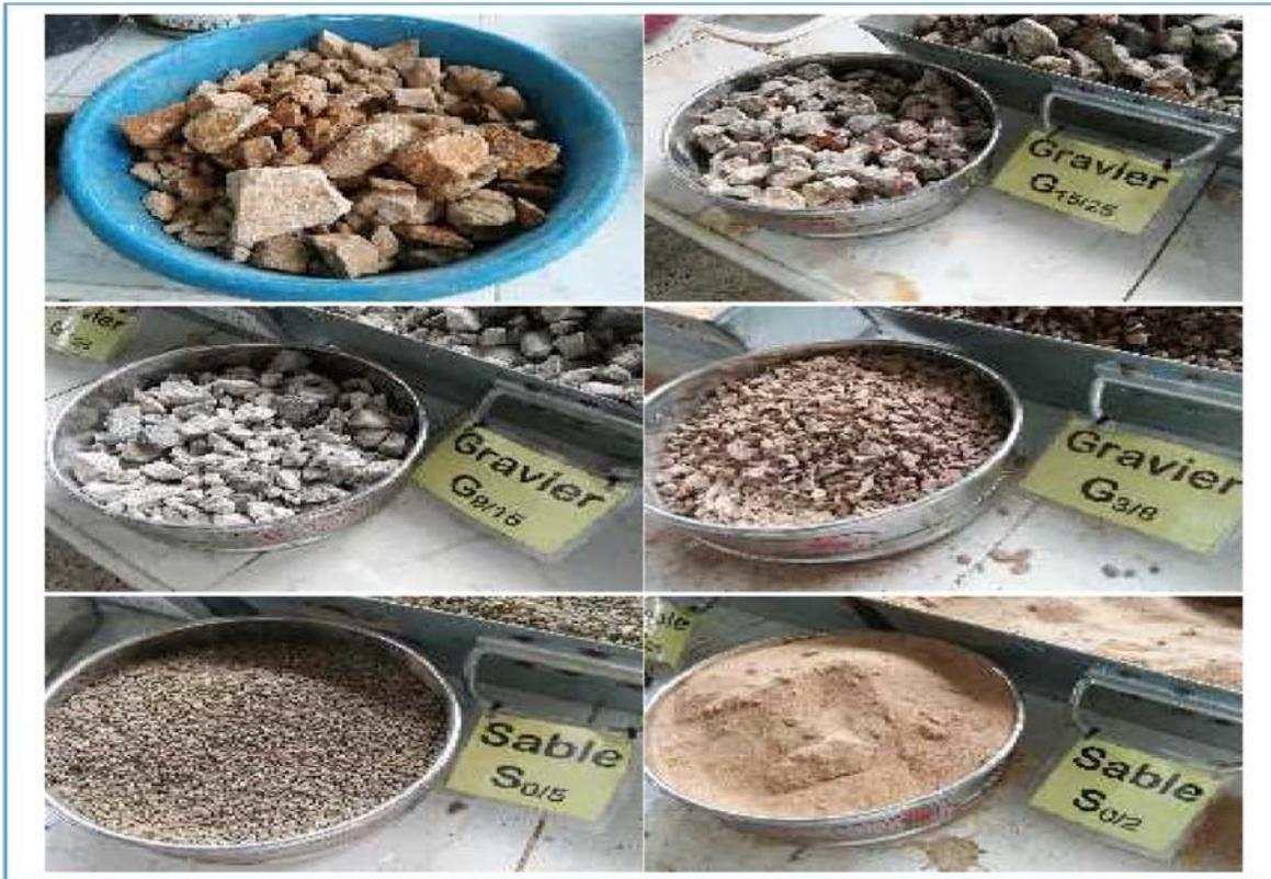
Figure IV.1 : Les granulats utilisés [17]
