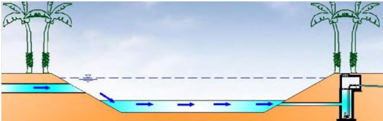
Figure4-40 : Evacuation et circulation naturelle des eaux
