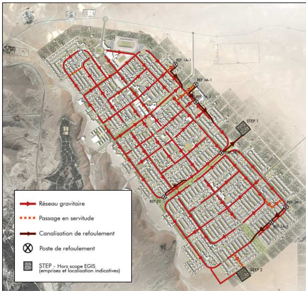
Figure 57 : Réseau des eaux usées ; source : Egis 2012.
