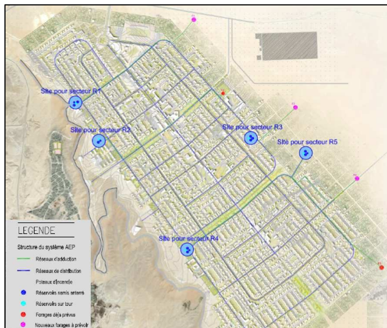
Figure 55 : Réseau d'alimentation en eau potable ; source : Egis 2012.
