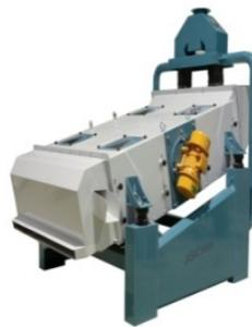
Figure 1.5 Séparateur par vibrations [5]
