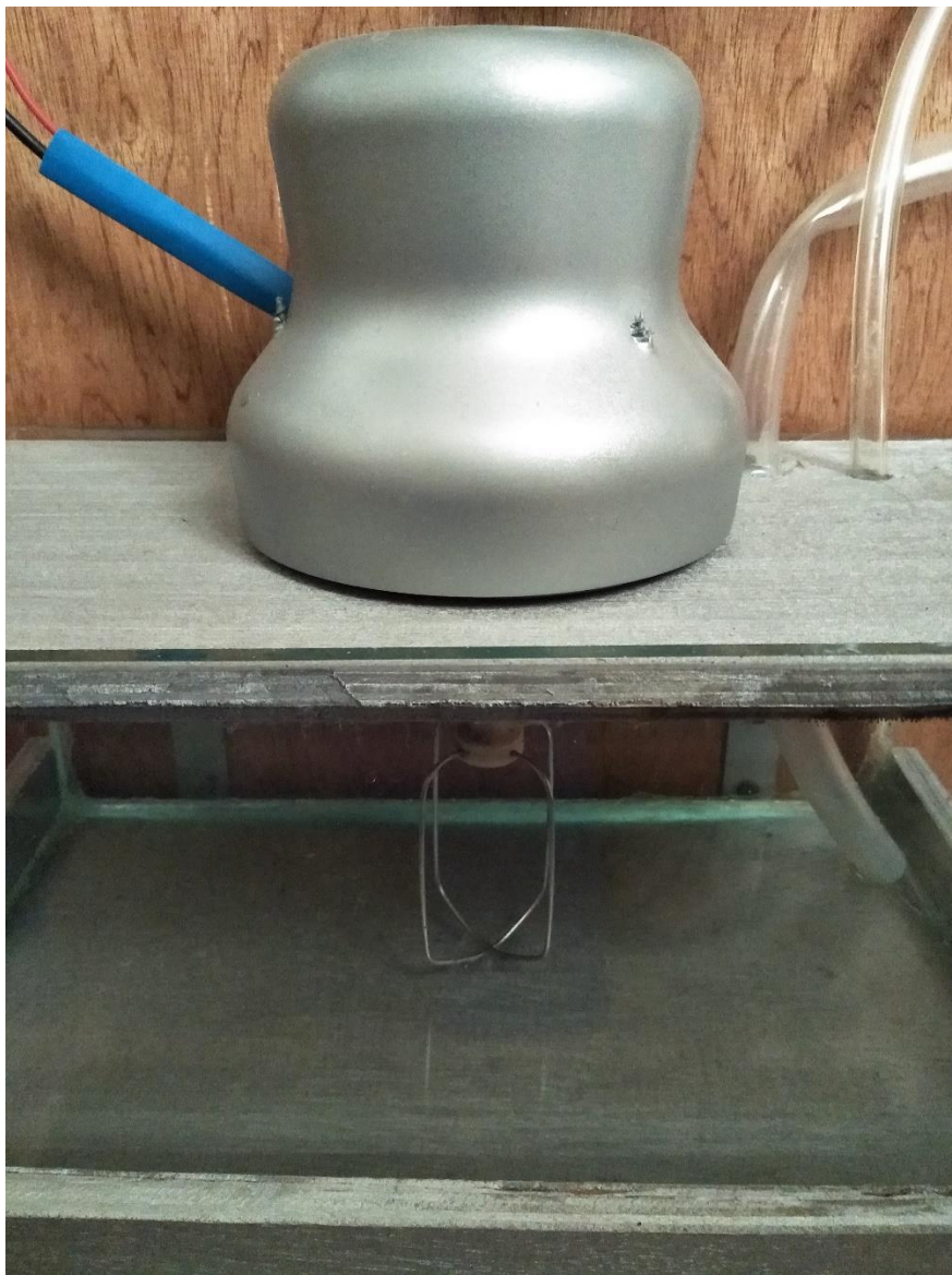
Figure 47: Moteur dans son boîtier équipée d'un fouet utilisé dans notre machine.
