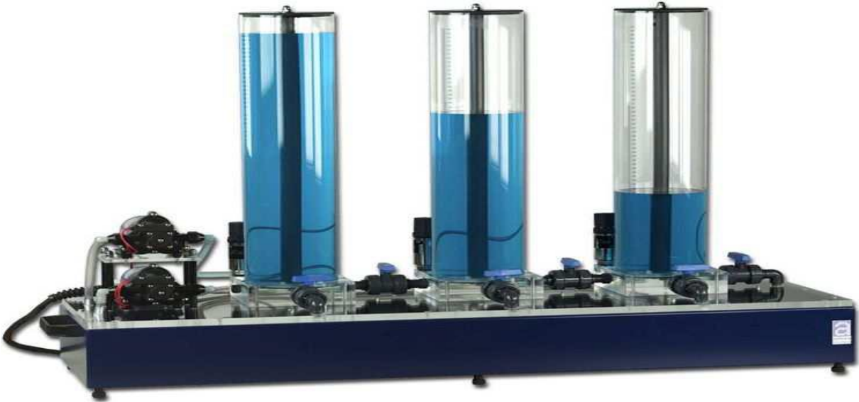
Figure I.4 : station hydraulique à trois cuves [15].
