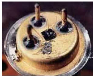
Fig. 2.8 : Premier transistor MOSFET réalisé par M. M. Atalla, D. Kahng et E. Labate en 1959[14]
