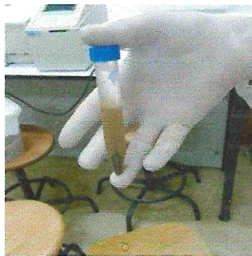
Photo 14 : Après la centrifugation, on obtient dans le tube 4 couches.
