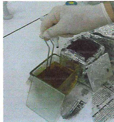
Photo 20 : Différencier dans de l'acide sulfurique à 2% pendant quelque secondes.
