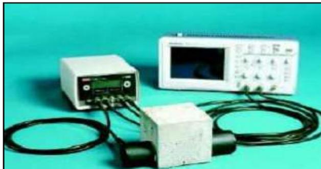
Figure I-15: Appareil d'auscultation par ultrasons. [11]
