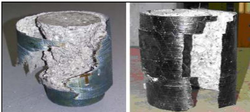
Figure I-42 : Rupture de colonnes renforcées par des confinements en fibres d'aramide et de carbone. [26]
