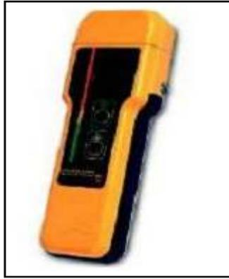
Figure I-21: L'hygromètre. [11]
