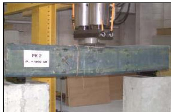
Figure I-44 : Essais d'effort tranchant sur des colonnes en béton avec ou sans renforcements par des tissus en CFRP. [26]
