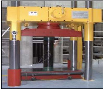
Figure I-40: Essais de compression sur des colonnes confinées. [26]
