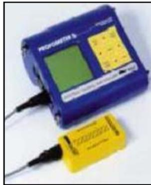
Figure I-17: Le profomètre. [11]
