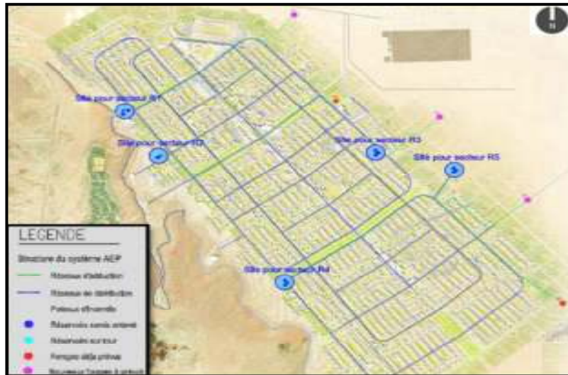
Figure III-13: Réseau d'alimentation en eau potable .Source : Egis 2012
