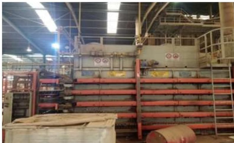
**Figure I.7. Séchoir horizontal**
