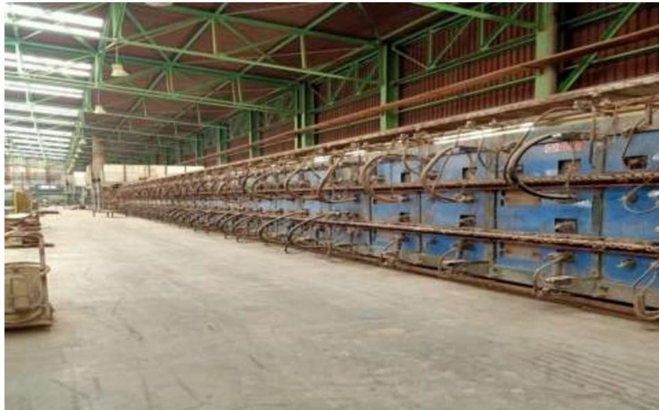
**Figure I.8. Four tunnel de cuisson**
