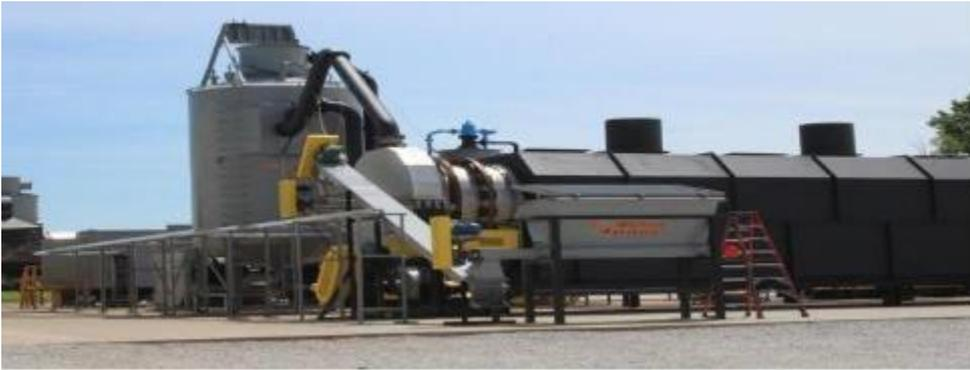
**Figure.II.3:** Photographie montrant l'unité de désorption thermique à Ourhoud [26].
