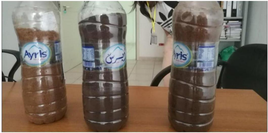
Figure II.5 : Photographie de trois échantillons du sable, non pollué, pollué, et traité par désorption thermique.
