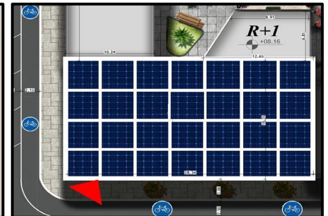
Figure 5.34 : panneaux photovoltaïque de la terrasse inaccessible du projet.
