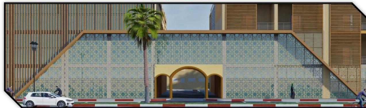
Figure 5.16: l'utilisation de l'arc et du moucharabieh traditionnel
