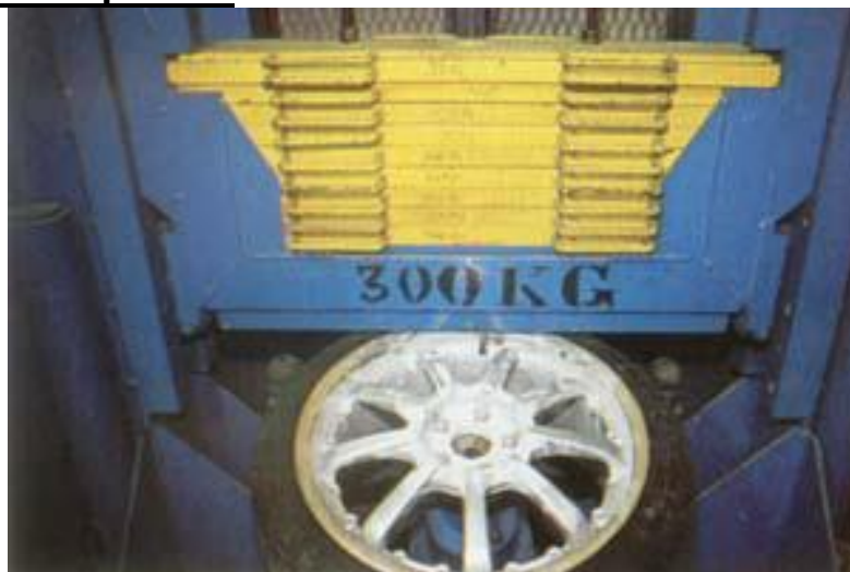
Figure III.13 : Avant la mise en fabrication d'une jante, elle Subit des tests de résistance, de fatigue du Métal, d'écrasement.
