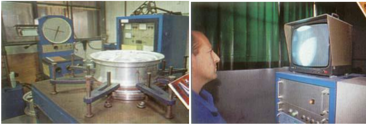
Figure III.14 : La qualité de l'alliage est elle aussi constamment contrôlée grâce à la radioscopie
