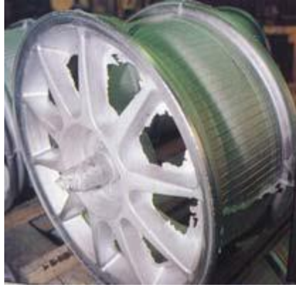
Figure III.7 : Voici le résultat brut de Fonderie, est-on tenté de dire ! Cette jante "première étape" Est automatiquement contrôlée par radioscopie.
