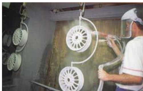
Figure III.11 : tour à tour la peinture et le vernis. Si le bord de la jante est diamanté, le vernis n'est pas Appliqué tout de suit
