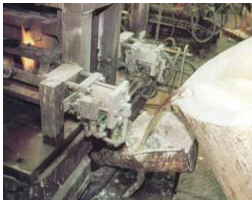
Figure III.6 : Première coulée de l'alliage dans le bac. Celle-ci est "décrassée" par l'apport d'azote. Les impuretés sont ôtées...
