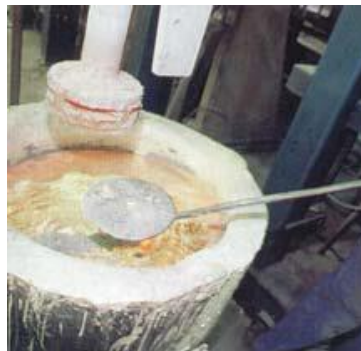
Figure III.5 : Le métal est injecté par basse pression pour remplir le moule. Il faudra de 3 à 6 min pour que la jante soit moulée avec 10 à 17 kilos d'alliage.
