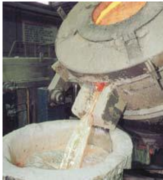
Figure III.3 : L'alliage est ensuite coulé dans le creuset
