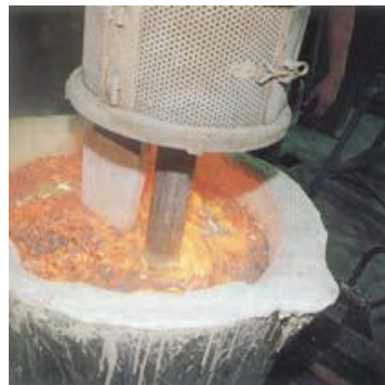
Figure III.4 : Il est dégazé et maintenu à température (740-750°C) par des résistances électriques
