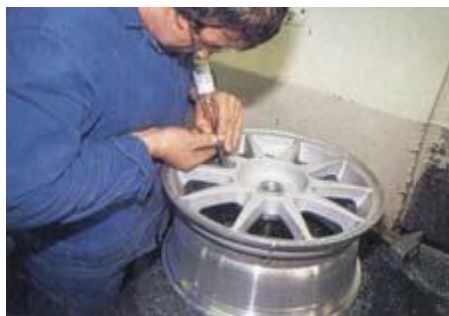
Figure III.9 : Un contrôle visuel est réalisé sur Toutes les jantes. On élimine ici Les dernières bavures d'alliage,
