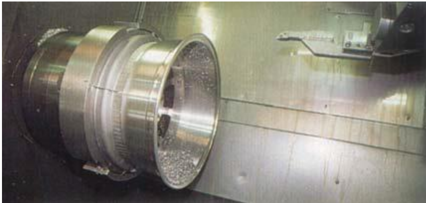
Figure III.8 : La jante passe ensuite à l'usinage sur un tour à commande Numérique. C'est lors de cette intervention que le profil de la Jante, le passage du freinage, le déport mais aussi l'alésage Central sont effectués.
