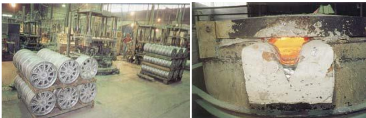
Figure III.2 : La première fusion des lingots se fait entre 740 et 750°C
