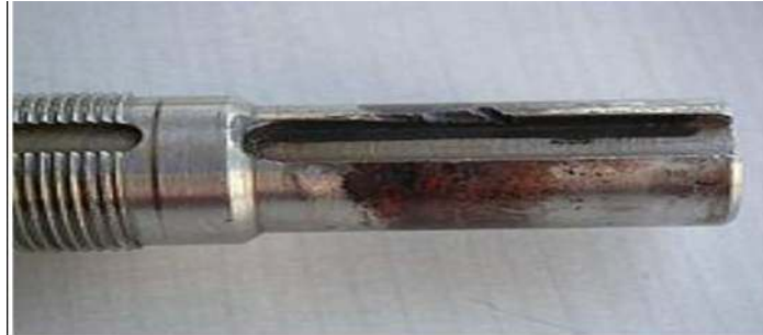
Figure 2.5: Usure par corrosion, usure chimique
