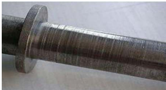
Figure 2.1: Pièce usée par abrasion
