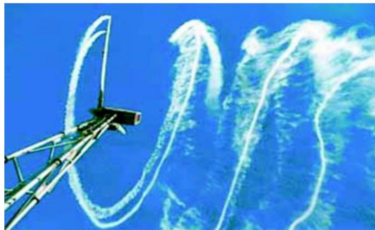
Figure 1-22 Structure du sillage en aval d'une éolienne, révélée par la fumée [37]
