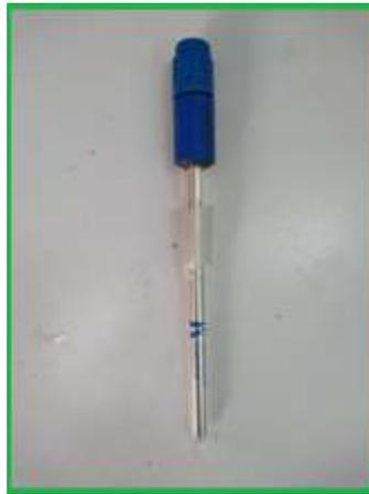
Figure 4.15 électrode auxiliaire.
