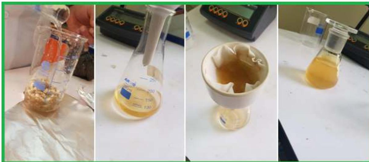
Figure 4.5 Extraction et filtration de l'inhibiteur.
