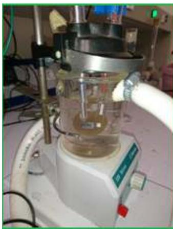
Figure 4.12 Cellule d'électrolyse en verre pyrex.
