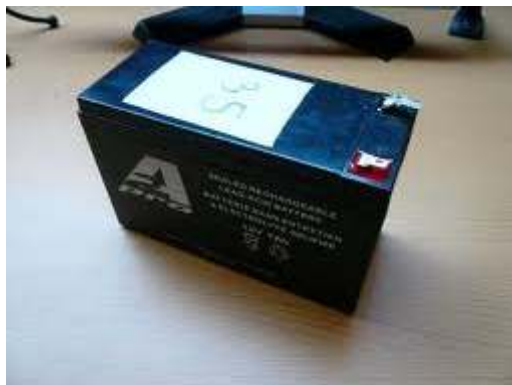
Figure 2. 2. Batterie utilisée 12v 7A
