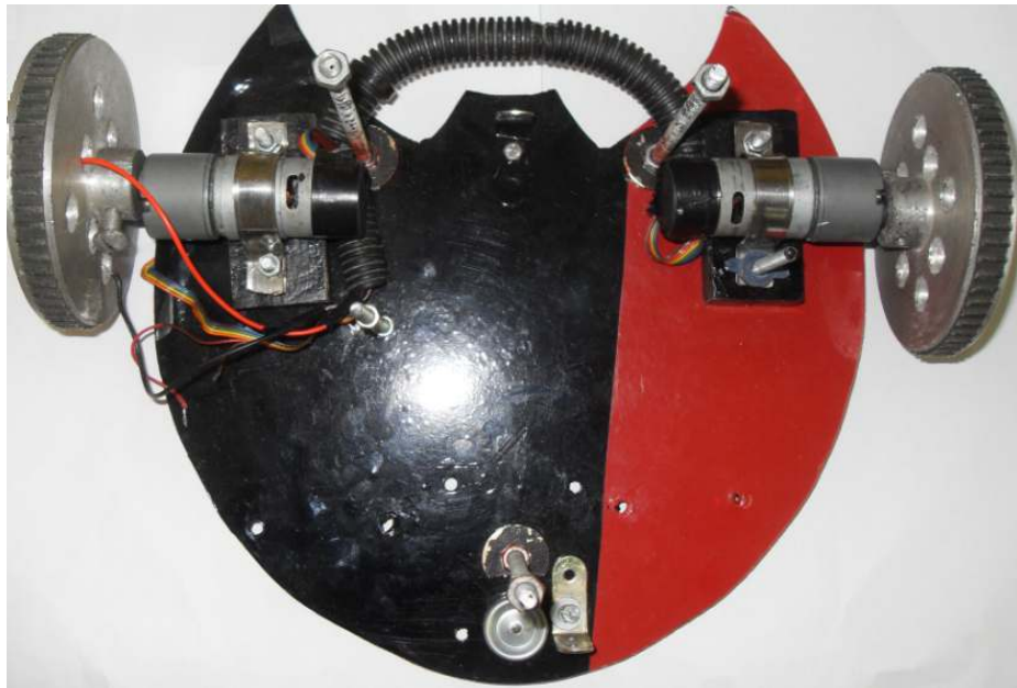
Figure 2. 1. Base mécanique du robot aspirateur
