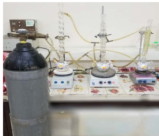
Figure :Schéma illustré le dispositif de la réaction d'oxydation catalytique de polluante
