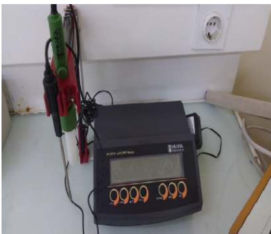
Figure :le pH-mètre utilisé (HANNA HI 2211)
