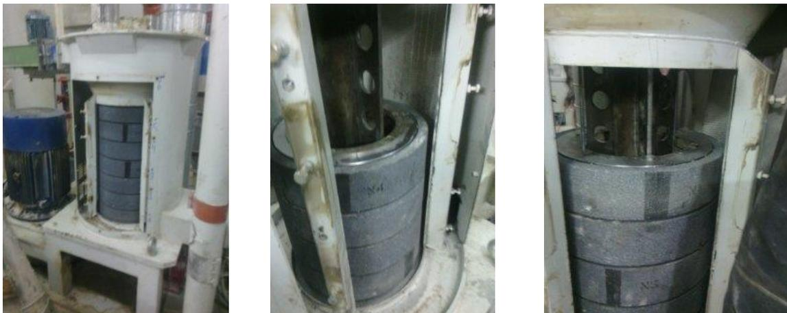
*Photo 4.1. Montage des pierres abrasives neuves de la décortiqueuse DH 202.*
