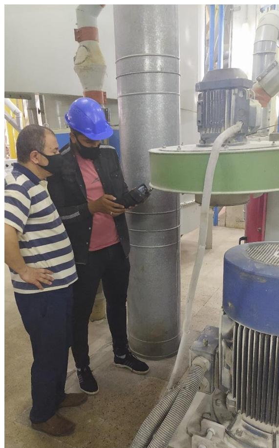
*Photo 4.3. Prise des mesures de vibration*
