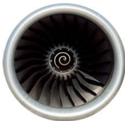
Figure I.6 : entrée d'air et soufflante [10]
